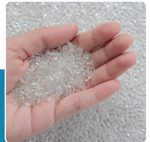
In der Sortier-Anlage werden die Flaschen kleingeschnitten. Die Plastik-Teilchen werden sortiert.
